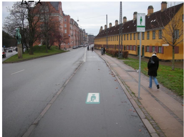
写真-3 コペンハーゲン 郊外部のグリーンウェーブ ・郊外から都心へ数本 ・時速20km/hで走行すれば信号に引っかからない
