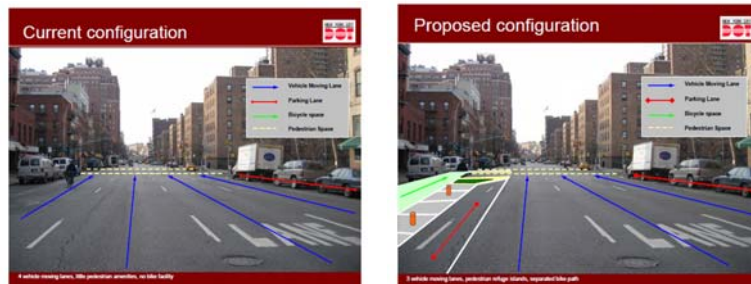
緑:歩道を舗装 青:車線を明確化+標識等設置 黄色:自転車レーン設置 赤:横断歩道を増設
